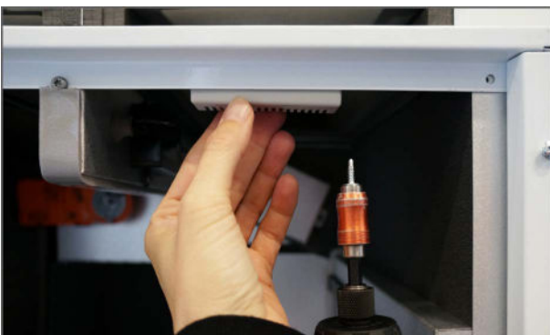
5. Asenna CO 2 -anturi yläkanteen itseporautuvien ruuvien avulla (sisältyy CO 2 -anturisarjaan).
