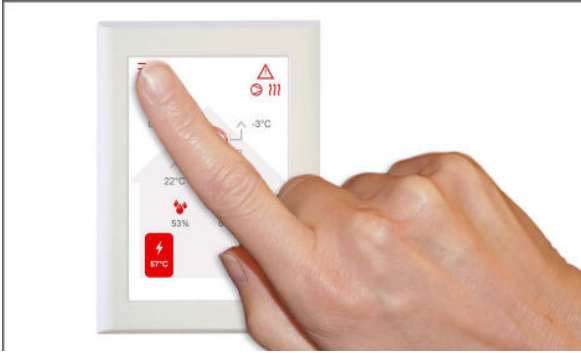
1. Ennen oven avaamista sammuta laite ohjainpaneliltä asetusvalikon kohdassa "Laite on / off".
