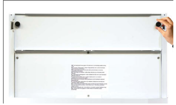
2. Avaa sormiruuvit laitteen oikeasta yläkulmasta ja avaa luukku
